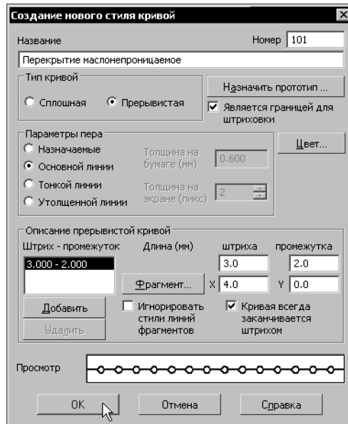
Рис. 8.10. Настройки стиля линии Перекрытие маслонепроницаемое
